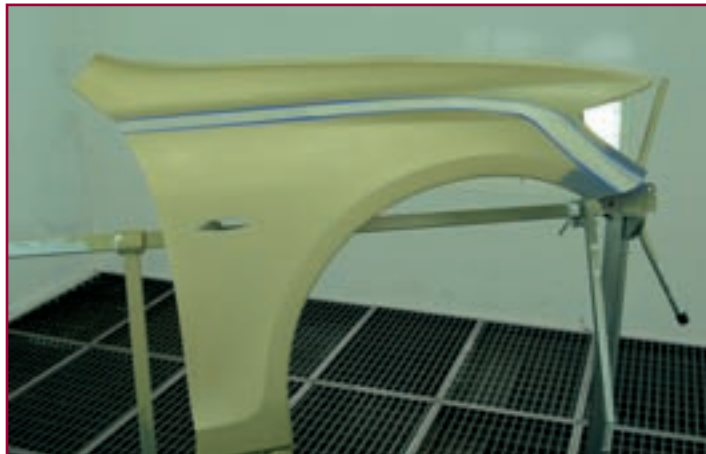
2. Наглядно показать возможность «плавного перехода» поможет малярная лента, идущая от места ремонта в сторону неповрежденного покрытия.
