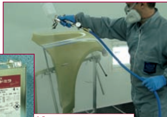
5. Ремонт «плавным переходом» начинают с нанесения Adjusting Clear на всю или почти всю поверхность детали.
