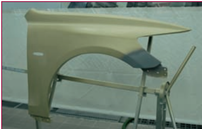
1. Для демонстрации метода на поврежденный участок нанесен и прошлифован грунт-наполнитель.
