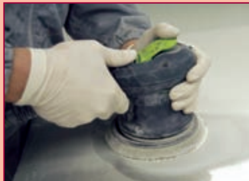
3. Поврежденный участок покрытия расшлифовывают шлифмашинкой с помощью абразивного материала зернистостью P220, а затем P320 до полного удаления царапины.
