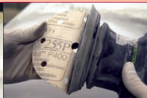
11. Начинают шлифовку грунта вручную абразивным материалом P320, предварительно нанеся на поверхность проявочное покрытие.
