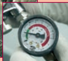
18. Слой базы paх Admila e 3 Gradator , нанесенный поверх краски, на глазах устраняет видимую границу старого и нового покрытий. Давление на входе в пистолет следует уменьшить до 1,5 бар, а сам пистолет приподнять на 20–25 см над поверхностью детали.
