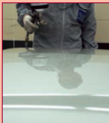
18. Слой базы paх Admila e 3 Gradator , нанесенный поверх краски, на глазах устраняет видимую границу старого и нового покрытий. Давление на входе в пистолет следует уменьшить до 1,5 бар, а сам пистолет приподнять на 20–25 см над поверхностью детали.
