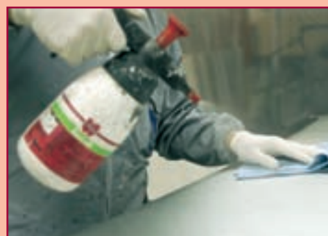
2. Ремонт начинают с обезжиривания всей детали. Для этого на ее поверхность наносят nax Silicon Off Degreaser и, не дав ему высохнуть, удаляют салфеткой вместе с загрязнениями.
