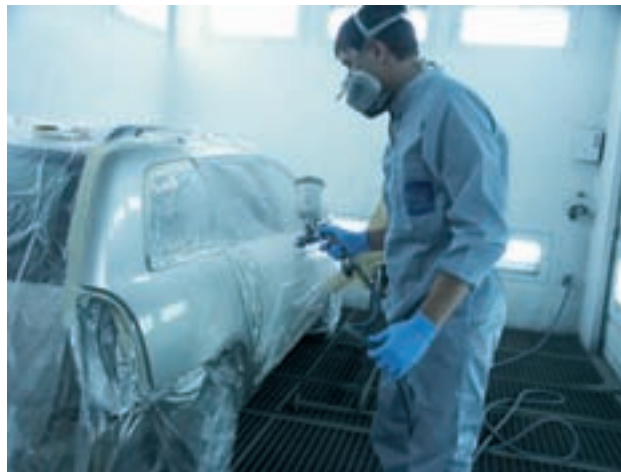
Технику нанесения лака демонстрирует технический эксперт компании «БИЗНЕС КАР» Александр Ходоров.
