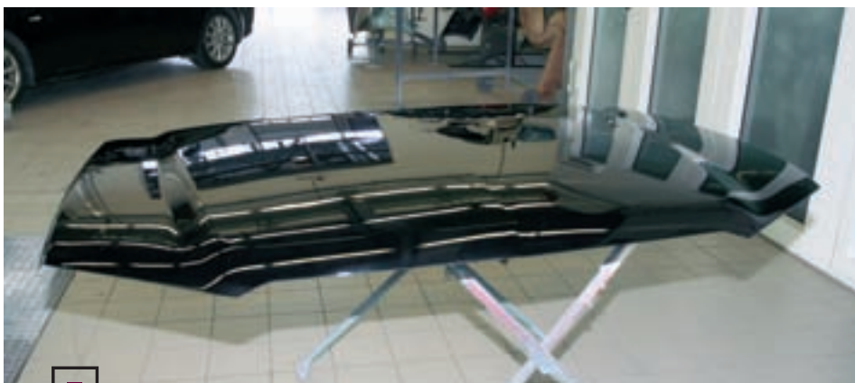
□ Нанесение керамического лака Mightylac New Ceramic Clear взамен обычного позволило повысить эксплуатационную стойкость покрытия капота и улучшило его внешний вид.
