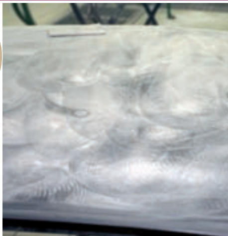
□ Капот, покрытый обычным лаком, шлифуется по стандартной «сухой» технологии абразивом P800–P1000.
