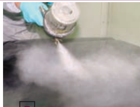
□ Лак смешивается с отвердителем в пропорции 2:1. В смесь добавляется 20% стандартного разбавителя пах Admila 500 Thinner. На капот наносятся три слоя лака «мокрым по мокрому» с промежуточной сушкой 5–7 мин.
